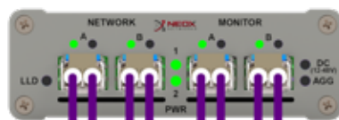
Link auf allen Ports vorhanden; jeweils linke LED leuchtet dauerhaft
