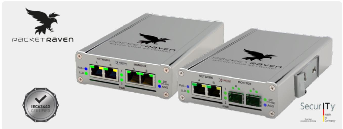
Kupfer-TAPs sind aktive Auskopplungselemente für den sicheren und zuverlässigen Abgriff von Netzwerkdaten in kupferbasierten Netzwerken. Dabei werden diese TAPs in die zu überwachende Netzwerkleitung eingeschleift und leiten den gesamten Datenverkehr unter Beibehaltung der Datenintegrität, unterbrechungsfrei und ohne Paketverluste aus.
